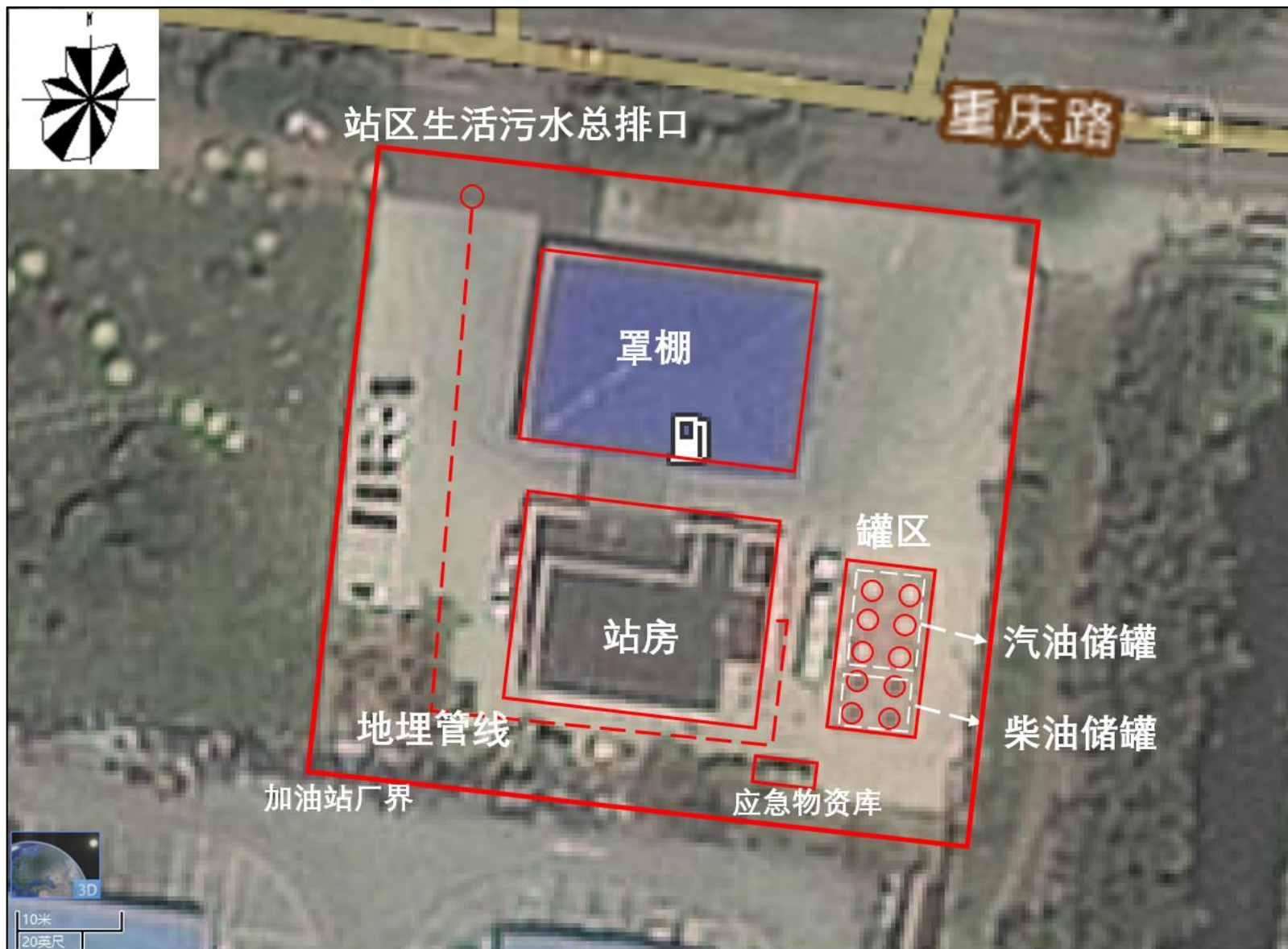
附图2 加油站平面布置图
