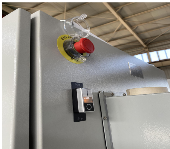
照片 12 操作台处急停按钮
