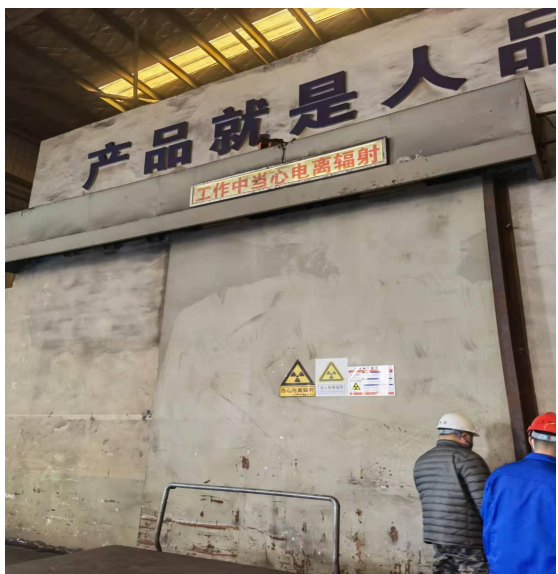
照片 11 工件进出防护门及指示灯
