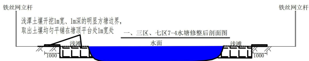
图 2-3 治理 1 区、3 区、7 区 7-4 水塘边坡整形示意图
